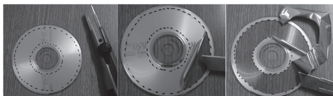
Figura 4. Es pot treure la capa d'alumini dels CD i el plàstic funciona com una xarxa de difracció per descompondre la llum.
