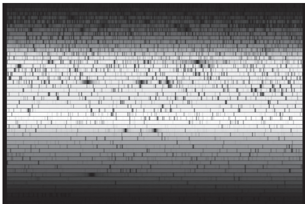
Figura 10. Línies de Fraunhofer en l'espectre del Sol. Les línies fosques són degudes a l'absorció dels elements de l'atmosfera solar. Alguns elements, com ara el ferro, són responsables d'un gran nombre de les línies espectrals. A la part de baix apareix la línia alfa de l'hidrogen; més amunt, el doblet del sodi; a sobre, el triplet del magnesi, i més amunt, la línia beta de l'hidrogen. A la zona del blau violeta hi ha emissions intenses de molts elements.
